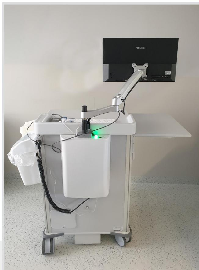
Bei diesem Kunden wurden die seit mehreren Jahren im Einsatz befindlichen Medicarts mit Keypad mit einem Back Pack mit eingebauter IT und zusätzlichem Bildschirm ausgestattet, so dass das Pflegepersonal keinen zusätzlichen Wagen oder separaten Laptop benötigt, um auch auf die EPA zuzugreifen. Auf Wunsch des Kunden wurde auch ein dezentraler Arm integriert.
